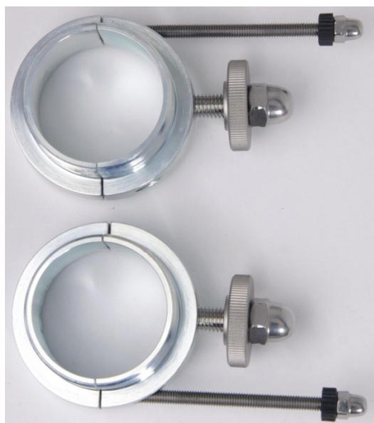
FITOOL P-FIX Verschraubungsklemmen-Komplettset DN 32 als P-FIX-Zubehör. Für den Einsatz in Pumpenanlagen DN 32 mit Überwurfmutter 2" ohne Absperrrichtungen. Bestehend aus zwei Paar Gewindehalbschalen Stahl galvanisch verzinkt mit Schneidring-Spannschrauben und abnehmbaren Gewinde-Verbindungsstangen mit Rändelgriffen.
