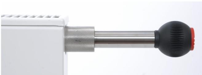
VENTILMAX-VENTILADAPTER aus Edelstahl als Zubehör für den VENTILMAX-SOLO. Mit 1/2" und M30x1,5 mm Innengewinde Für Ventilheizkörper und Ventile mit M30x1,5 mm Anschlussgewinde.
