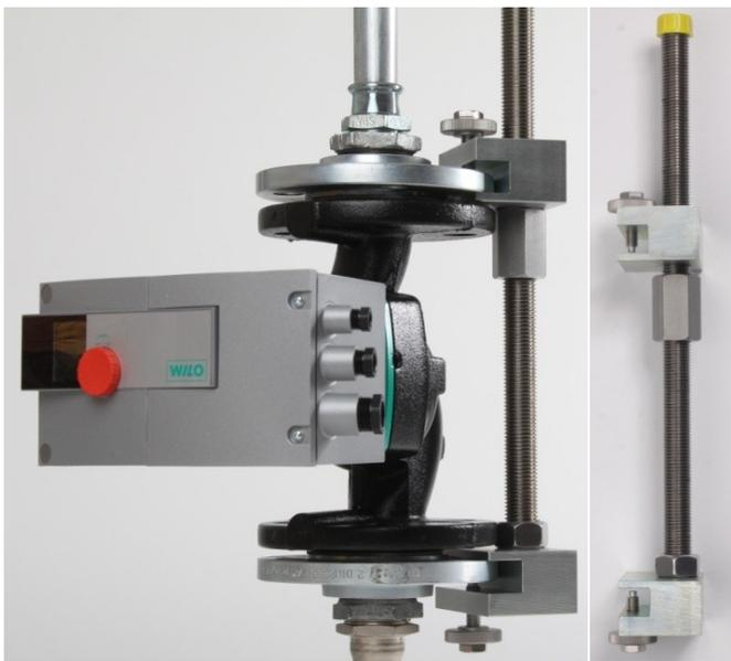
FITOOL FLANSCHMASTER (**Basis-Ausführung F360**) Montagevorrichtung für Flansch-Heizungspumpen und Flansch-armaturen **DN 32 bis DN 100 bis Baulänge 360 mm**, (Flansche nach DIN EN, Flanschstärke bis 20 mm, mind. 2 mm Dichtleiste). Bestehend aus zwei galvanisch verzinkten Flanschhalte-schienen mit Edelstahl-Gewindebolzen mit Spannmutter. Mit zwei Arretierungs-schrauben mit Rändel und Sechskantauf-nahme.
