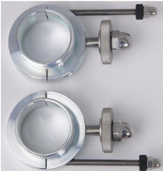
FITOOL P-FIX Verschraubungsklemmen-Komplettset DN 25 als P-FIX-Zubehör. Für den Einsatz in Pumpenanlagen DN 25 mit Überwurfmutter 1 1/2" ohne Absperrrichtungen. Bestehend aus zwei Paar Gewindehalbschalen Stahl galvanisch verzinkt mit Schneidring-Spannschrauben und abnehmbaren Gewinde-Verbindungsstangen mit Rändelgriffen.
