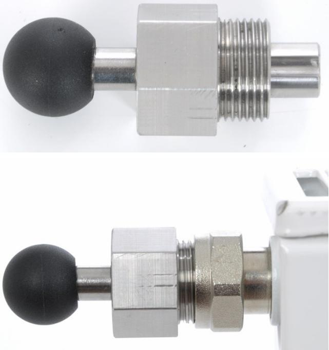
VENTILMAX-SMART Einschraubwerkzeug aus Edelstahl massiv mit Kugelknopf aus Thermoplast. Für Heizkörperventile DN 15 (1/2") mit Innennocken-Ventilnippel. Mit Verschraubungs-Aussengewinde 3/4" für Heizkörperventil-Überwurfmutter und mit Aufnahmebolzen. Mit aussen angeordneter Sechskantaufnahme SW 30.
