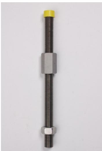
FITOOL FLANSCHMASTER Kurzgewinde-bolzenset als Zubehör für Flanschmaster 107040. Für Flansch-Heizungspumpen DN 32 und Flansch-schieber bis Baulänge 220 mm. Bestehend aus Edelstahl-Gewinde-bolzen mit Kurzlänge 325 mm, Befestigungsmutter, Spannmutter und Schutzkappe.
