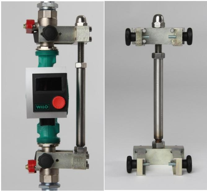
FITOOL P-FIX Montagevorrichtung für Heizungs-Rohreinbaupumpen DN 25 und DN 32 mit Baulänge 180 mm. Geeignet auch für waagrechte Wasserzähler DN 20 mit Baulänge 190 mm und DN 25 mit Baulänge 260 mm. Bestehend aus vier Wechsel-Aufnahmeschienen und zwei Halteschienen Stahl galvanisch verzinkt. Mit Edelstahl-Gewindebolzen, Edelstahl-Spannhülse, Edelstahl-Befestigungs- und Edelstahl-Spannmutter sowie Arretierungs und Wechselschrauben.
