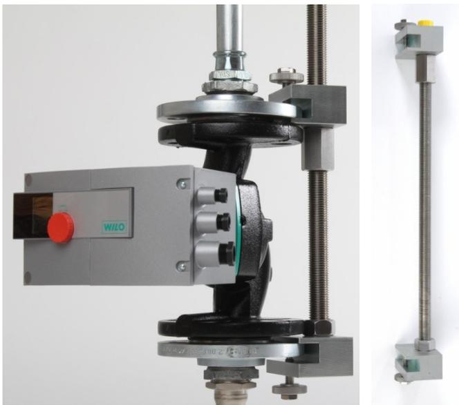
FITOOL FLANSCHMASTER (**Verlängerte Ausführung F480**) Montagevorrichtung für Flansch-Heizungspumpen und Flanscharmaturen **DN 32 bis DN 100 bis Baulänge 480 mm**, (Flansche nach DIN EN, Flanschstärke bis 20 mm, mind. 2 mm Dichtleiste). Bestehend aus zwei galvanisch verzinkten Flanschhalte-schienen mit Edelstahl-Gewindebolzen mit Spannmutter. Mit zwei Arretierungsschrauben mit Rändel und Sechskantaufnahme.
