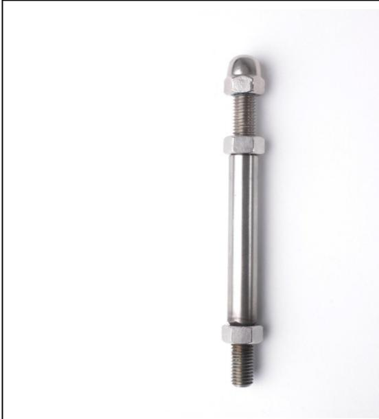
FITOOL P-FIX Kurzgewindebolzenset als Zubehör für Heizungs-Rohreinbaupumpen mit Sonderlänge 130 mm. Bestehend aus Gewindebolzen mit Spannhülse, Befestigungsmutter und Spannmutter komplett aus Edelstahl.
